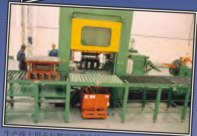
生产线上用于与机床工作台连接实现快速换模
